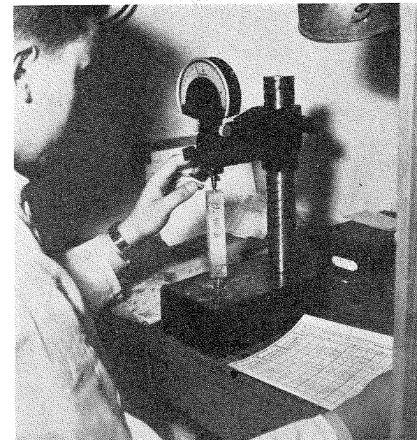
Fig. 9. Måling af mørtelprismers længdeændring.
