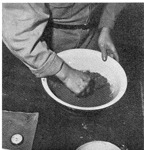
Fig. 6. Blanding af mørtel ved mørtelprismeforsøg.
