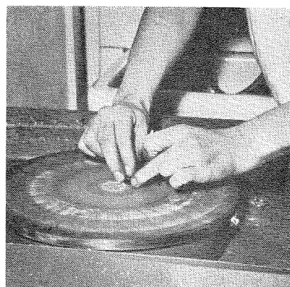
Fig. 36. Roterende, vandret liggende slibeskive. Skivediametere er 35 cm, og der kan benyttes to hastigheder, 500 og 200 omdrejninger pr. minut. Som slibemiddel benyttes karborundum eller borkarbid opslemmet enten i vand eller i petroleum.
