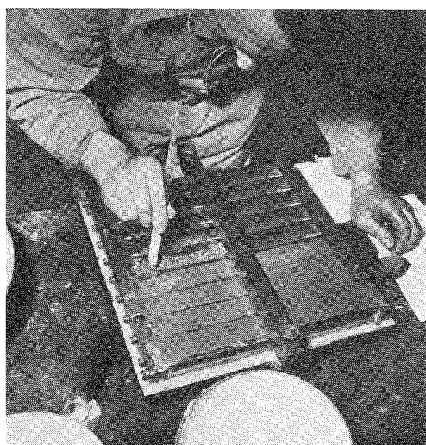
Fig. 7. Udstøbning (bearbejdning) af mørtelprismer.
