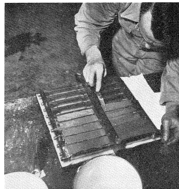
Fig. 8. Udstøbning (afretning) af mørtelprismer.
