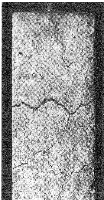
Fig. 21. Revneforløbet hos et kraftigt ekspanderet mørtelprisme. Der er anvendt porøs Erslevflint med kornstørrelse \frac{1}{8} \leq d \leq \frac{1}{4} \pm mm og blandingsforhold meget nær det pessimale. Prismet er fuldstændigt gennemrevnet.
